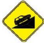
PENDIENTE PELIGROSA (SUBIDA)
