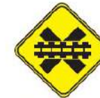
PASO A NIVEL SIN BARRERA
