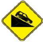
PENDIENTE PELIGROSA (BAJADA)
